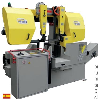
Sierra de cinta de tipo automático para cortes a 0°. CN de serie para poder realizar cortes de diferentes cantidades y longitudes dentro de un mismo programa. Arco, mordaza y carro se mueven por medio de cilindros hidráulicos.
